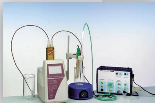
Kit de titrage automatique avec Cobra3 ChemUnit
