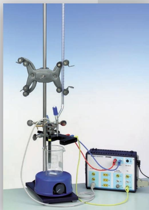
Kit de titrage pH avec compteur de gouttes et Cobra3 ChemUnit
